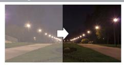
Wenn die Sicht durch Nebel oder Rauch beeinträchtigt wird, passt diese Funktion die Werte für Farbe, Kontrast und Kantenschärfe an, um ein klareres Bild zu erhalten.
