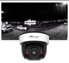
Bei schlechten Lichtbedingungen, zum Beispiel nachts, schaltet die Kamera automatisch in den Schwarz/Weiß-Betrieb um. Die Sicht wird zusätzlich durch die integrierte Infrarotbeleuchtung unterstützt. Die Kamera besitzt einen eingebauten Infrarot-Sperrfilter (IR-Cut-Filter). Damit werden störende Einflüsse der IR-Strahlung auf die Abbildungsqualität des Sensors vermieden.
